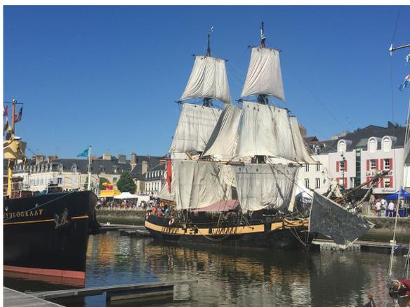
Le PHOENIX brick-goélette de 1929, construit au Danemark Long 34,1 coque 23,8 larg 6,6 tirant d'eau 2,4 poids 78 T et voiles 370 m2
